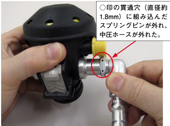
図2 不具合箇所 (プレッシャデマンド弁)
