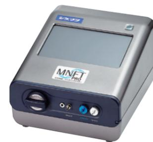
MNFT PRO は、呼吸用保護具の内側と外側の大気じんの個数を測定する装置です。フィットテスト用としてフィットファクタを求めることができます。また、**フィットファクタ又は漏れ率と面体内圧をリアルタイムで表示**できるので、日常の装着訓練や呼吸用保護具の教育用としても使用できます。
