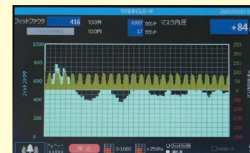
PAPR「呼吸連動形シンクロ」は、マスク内圧を陽圧(正圧)に保持するため、安全性が高いマスクです。面体がズレてもファンが作動しているので、粉じん等を吸入するリスクを低減します。PAPR: Powered Air Purifying Respirator (電動ファン付き呼吸用保護具)
